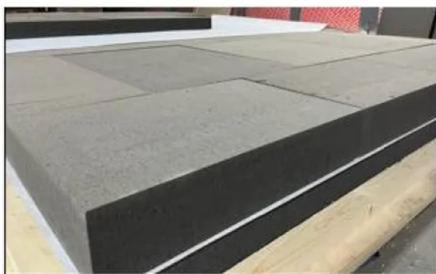
Lose verlegbare Schaumglasplatten auf Flachdach
