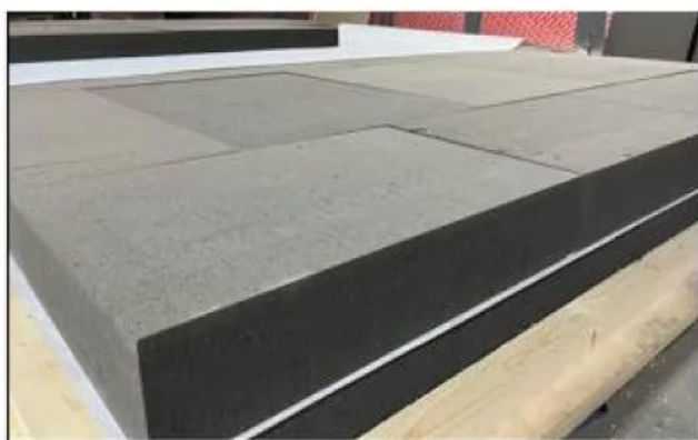
Lose verlegbare Schaumglasplatten auf Flachdach
