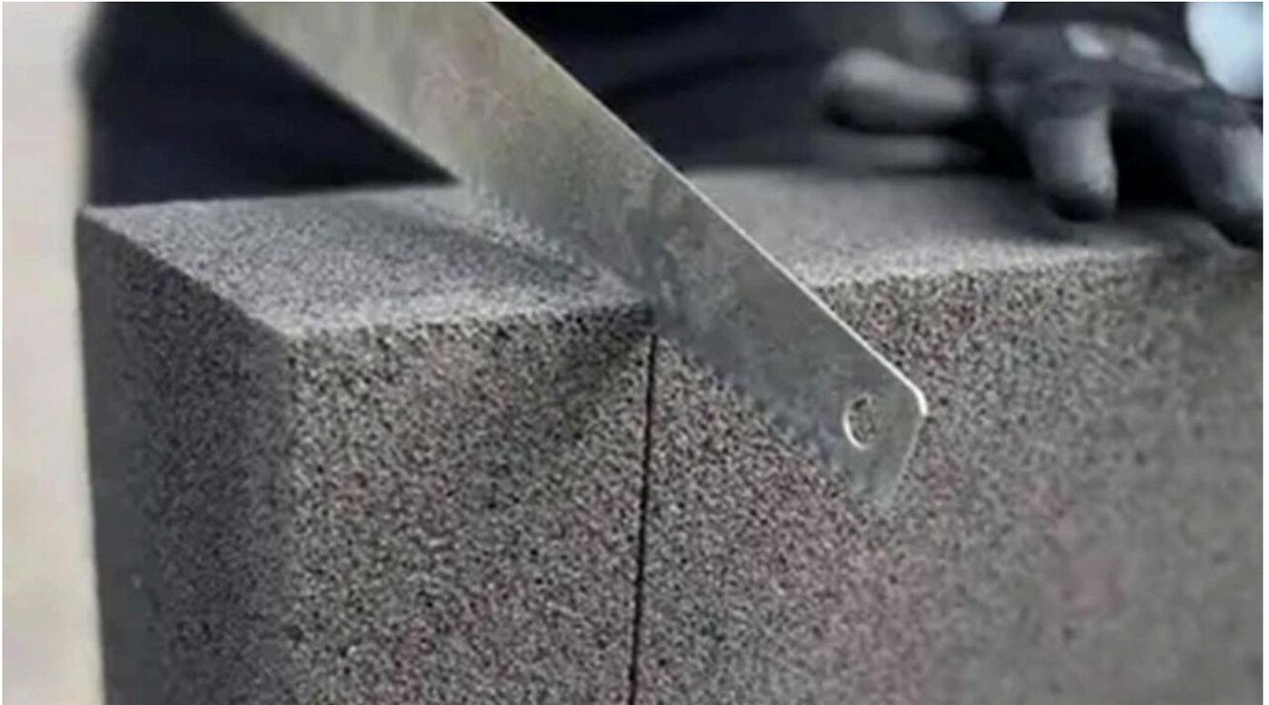
GLAPOR Schaumglasplatten sind formstabile Dämmstoffe aus expandiertem Recyclingglas mit geschlossenzelliger Struktur, die eine dauerhaft konstante Wärmeleitfähigkeit gewährleisten.
