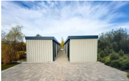
Gerätehaus Reihenanlage Metall MZH als Kellerersatzraum für Wohnanlage, zweifarbig pulverbeschichtet
