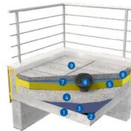
Systemskizze: Gefälledämmung mit GEOMATERIALS Blähglas
