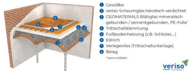
Systemskizze: Gewölbedämmung mit GEOMATERIALS Blähglas
