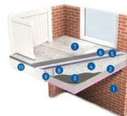
Systemskizze: Thermische Sanierung von Balkonen mit GEOMATERIALS Blähglas
