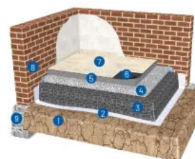
Systemskizze: Fußbodensanierung - Kombination GEOMATERIALS Schaumglas & Blähglas
