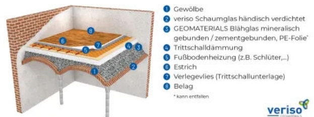
Systemskizze: Gewölbedämmung mit GEOMATERIALS Blähglas
