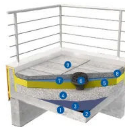
Systemskizze: Gefälledämmung mit GEOMATERIALS Blähglas
