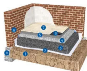
Systemskizze: Fußbodensanierung - Kombination GEOMATERIALS Schaumglas & Blähglas
