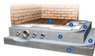
Systemskizze: gebundene Ausgleichsschüttung mit GEOMATERIALS Blähglas
