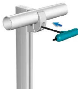
Montageschritt 2: Klemmhalter sicher fixieren
