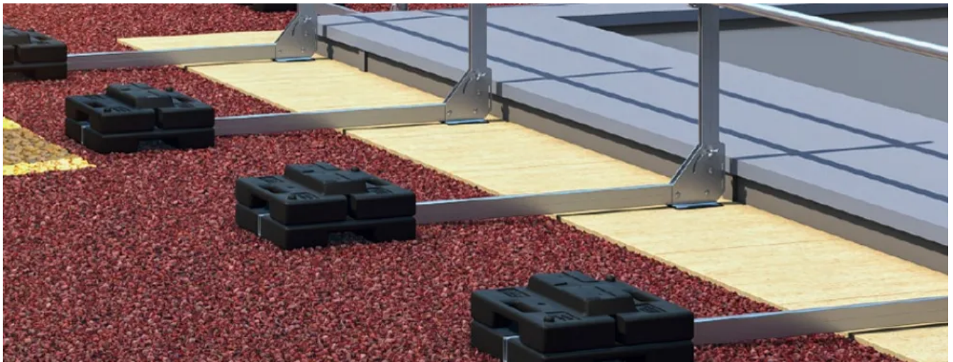
Gegengewichte für Barrial® Eco – sichere Auflast ohne Durchdringung der Abdichtung
