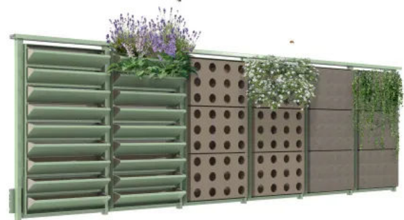
Modulvarianten: Substratmodul | Modul mit Pflanztöpfen | Geotextilmodul
