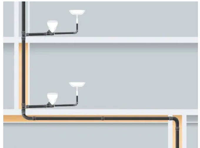
Konventionelle Entwässerungsinstallation nach DIN EN 12056
