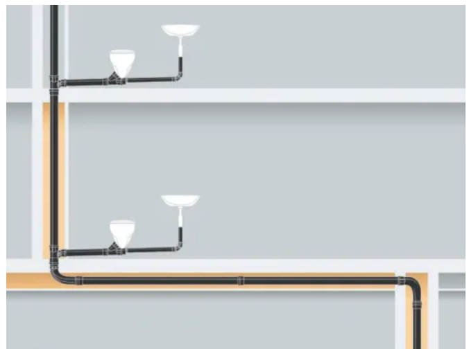
Konventionelle Entwässerungsinstallation nach DIN EN 12056
