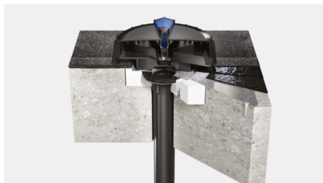
Betondächer mit Bitumen-Dachabdichtung
