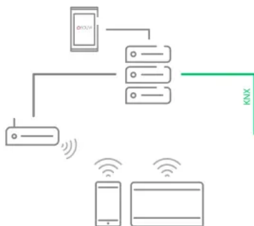
Als Client-Lösung mit externem Server & IP-Router
