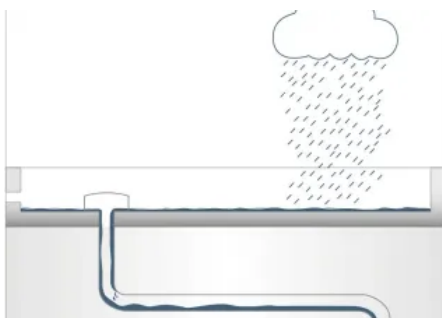
Bei geringen Niederschlägen erfolgt die Entwässerung nach dem Schwerkraftprinzip. | © ACO Haustechnik
