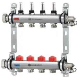
Flächensysteme-Verteiler zum Heizen und Kühlen mit automatischer Durchflussregelung
