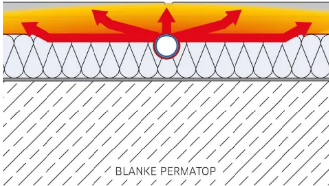
BLANKE PERMATOP Wärmeverteilung
