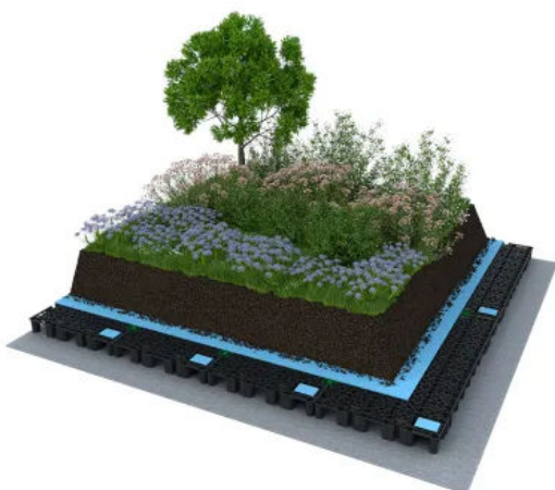
Aufbau Retentionsdach Drossel Intensiv – © Optigrün
