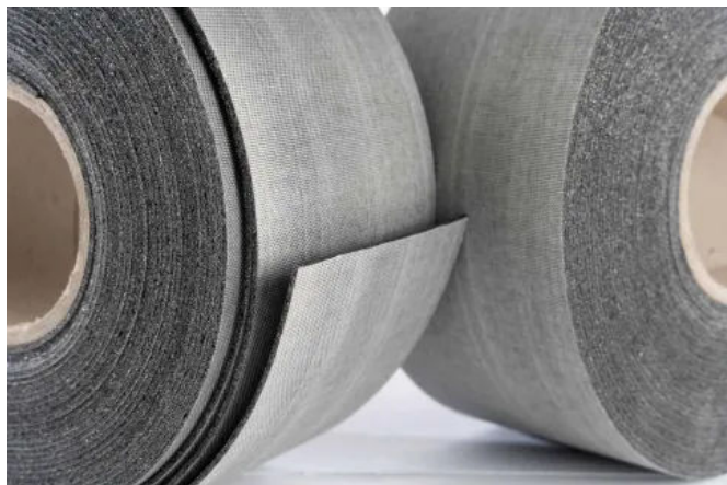
Flaton-flex A ist ein flexibles, im Brandfall aufschäumendes Fugendichtband für Bauteilfugen im Holzbau, das Feuer-, Wärme- und Rauchübertragung verhindert.
