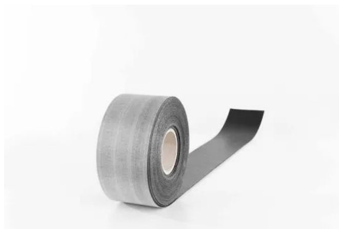
Das 100 mm breite Fugendichtband kann mit Tackerklammern einfach in der Fugenmitte am Holzbauteil befestigt werden.
