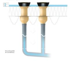
Prinzip der Freispiegelentwässerung mit Stauhöhe der Hauptentwässerung (h1) und Notentwässerung (h2)
