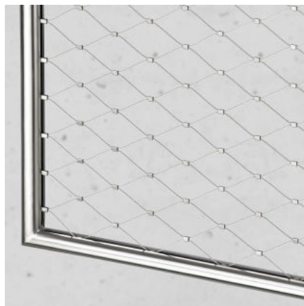
INVISS-R: Rundrohrrahmen geschlitzt, ohne Randseil, Rohrdurchmesser 26,9 mm.
