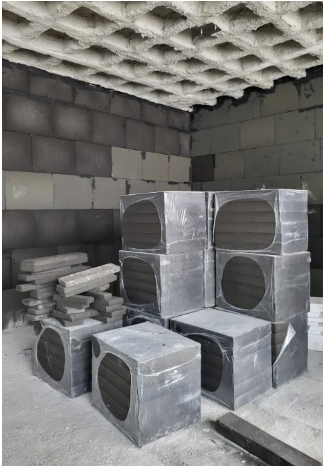
Die Druckfestigkeit von Foamglas T3+ beträgt \geq 500 kPa. Der Einsatz ist in mechanisch beanspruchten Dach- und Anschlussbereichen vorgesehen. (© OC FOAMGLAS®)
