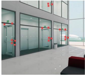
Fluchtwegsicherung SafeRoute: Vier Türen mit Fluchtwegsicherungssystem
