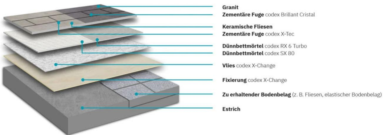
Das Wiederaufnahmesystem codex X-change ermöglicht die sichere Verlegung und den schnellen Austausch von Fliesen und Natursteinbelägen.
