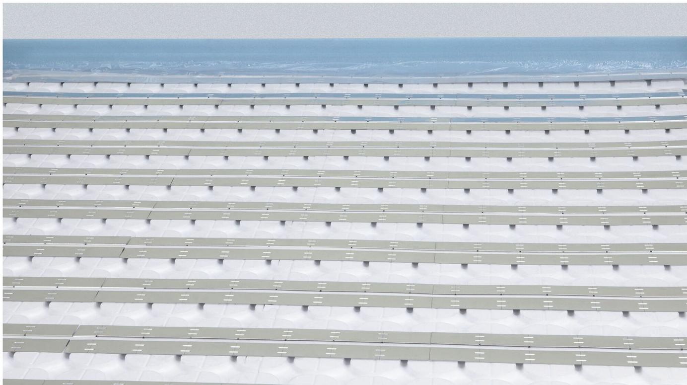
Die Verlegung der Fußbodenheizung mit der Trockenbauplatte von SCHÜTZ geht denkbar einfach in drei Schritten: Dämmplatten auslegen, Wärmeleitmodule und Rohre einfügen und als letztes den Trockenestrich verlegen. Einfache Montage, geringe Aufbauhöhen und hohe Wirtschaftlichkeit zeichnen diese Variante der Flächenheizung aus.
