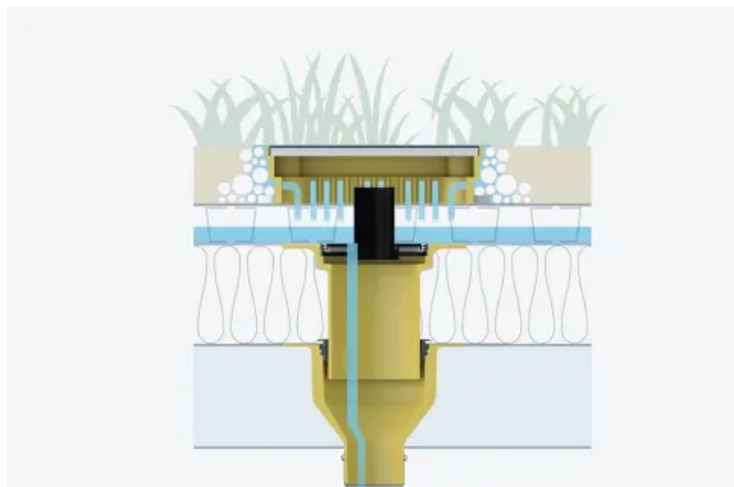
Zur verzögerten Entwässerung: SitaRetention Fix
