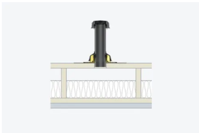
B. Eingebaut in einem belüfteten Dachaufbau: SitaVent Kaltdachlüfter
