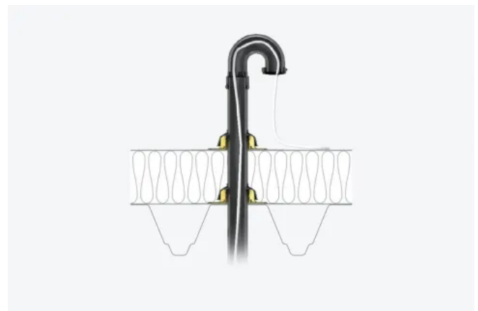
C. Eingebaut in einem nicht belüfteten Dachaufbau: SitaVent Rohrdurchführung
