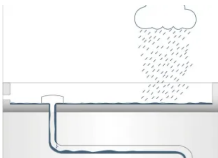
Bei geringen Niederschlägen erfolgt die Entwässerung nach dem Schwerkraftprinzip. I © ACO Haustechnik
