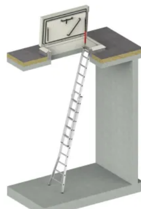
Staka ThermoTop Flachdachausstieg mit Leiter für Geschosshöhen bis 10 Meter
