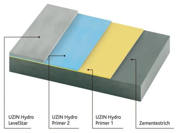
Feuchtesperresystem UZIN HYDROBLOCK
