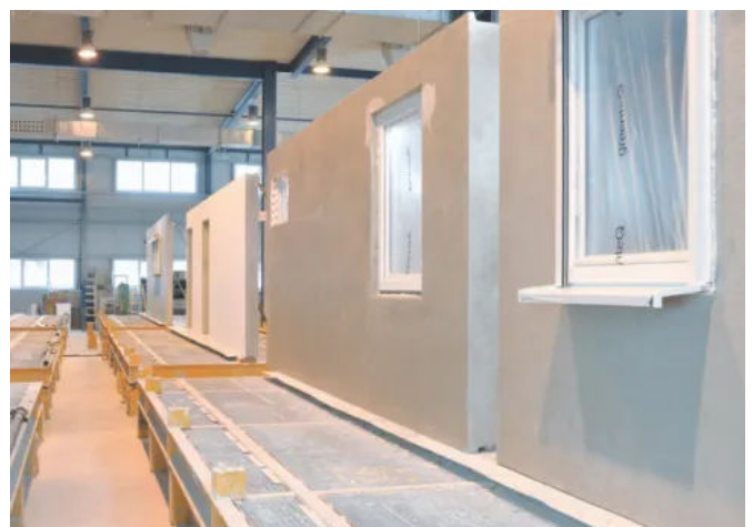
Vorgefertigte Wand - Kalksteinwandtafeln
