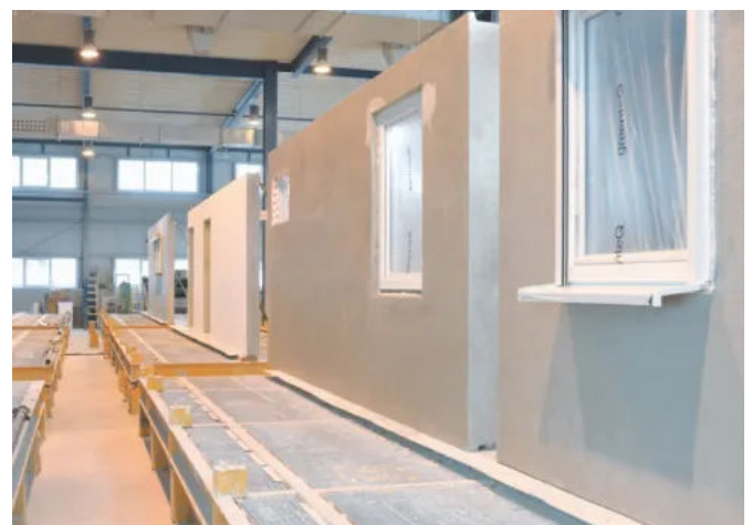
Vorgefertigte Wand - Kalksteinwandtafeln
