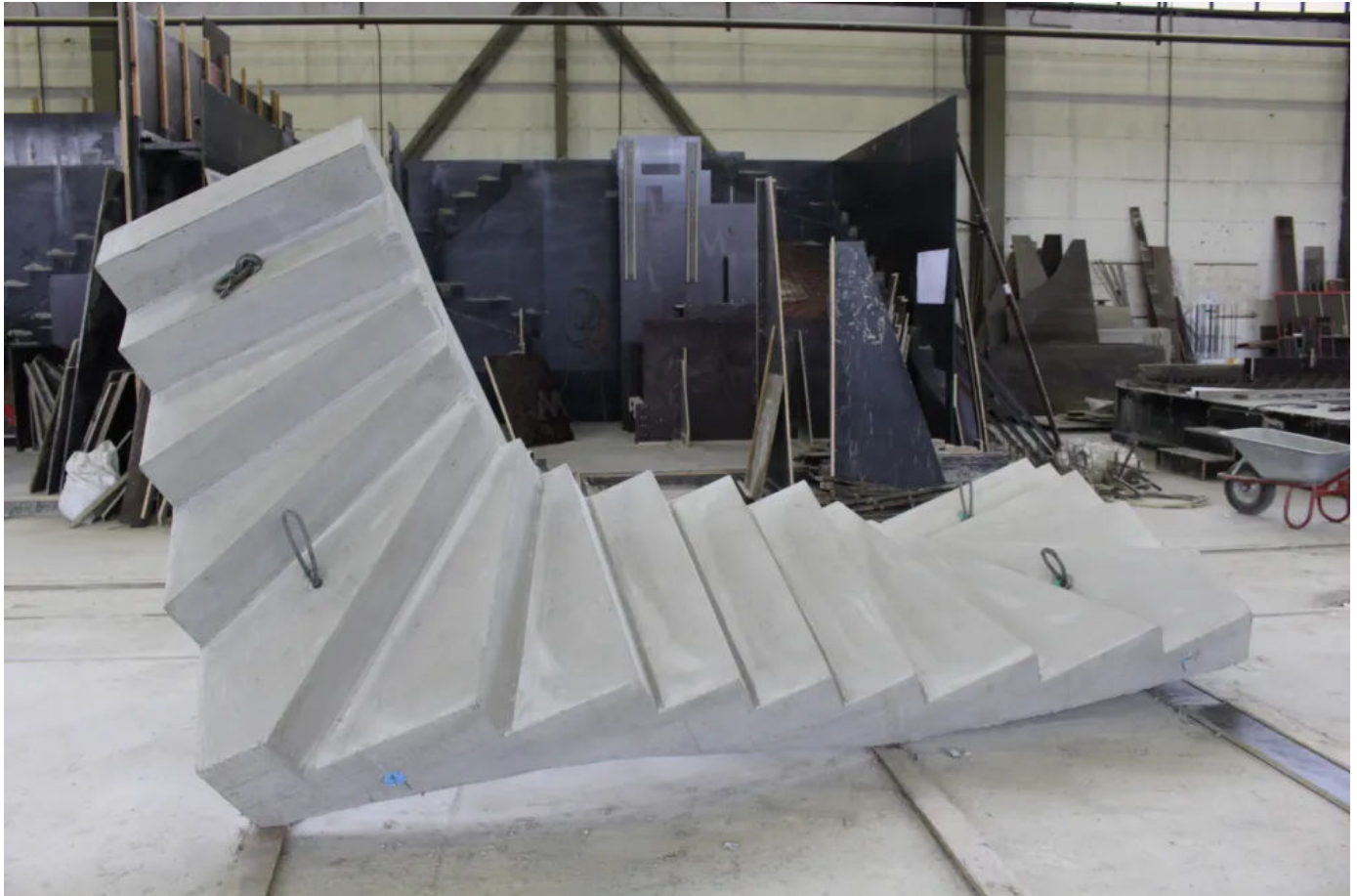
Gewendelte Treppen werden ganz nach individuellen Kundenwünschen in Holzschalung im Positivverfahren hergestellt.
