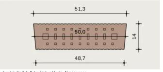
Lehmstein für Holz-Beton-Verbunddecke, Abmessungen
