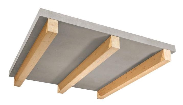
Die Holz-Beton-Verbunddecke ist ein Hybridbauteil aus Holzelementen, die mit einer darüber liegenden Stahlbetonplatte und speziell zugelassenen Verbindungsmitteln einen schubfesten Verbund bilden.
