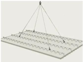
Systemskizze Betonfertigteil-Plattendecke mit Transportanker
