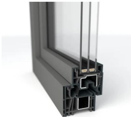
Das System GEALAN-LINEAR® verfügt über sehr gute wärmedämmtechnische Eigenschaften bei einer Bautiefe von 74 mm. Die sechs Kammern im Blendrahmen sowie die fünf Kammern im Flügel unterstützen die gute Wärmedämmung. Die innovative Mitteldichtung sorgt für eine Unterbrechung des Wärmestroms von innen nach außen.
