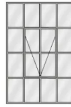
Senkklapp-Fenster nach aussen öffnend
