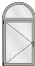
Einflügeliges Fenster mit Rundbogen-Oberlicht
