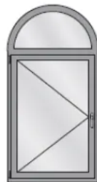
Einflügeliges Fenster mit Rundbogen-Oberlicht
