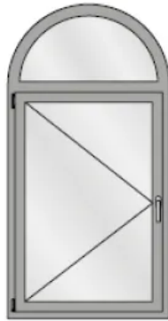
Einflügeliges Fenster mit Rundbogen-Oberlicht
