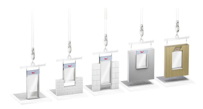
Das Fenster-Komplettsystem WINDOWMENT® umfasst alle für die Herstellung notwendigen Komponenten und ermöglicht eine präzise Fertigung in der Werkhalle. Anschließend wird das Fenster mit allen angrenzenden Bauteilen verheiratet und auf die Baustelle geliefert, wo es mit dem Baukran direkt in das Mauerwerk gesetzt wird.
