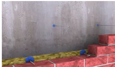
MOSO® HV-D Drahtanker für die nachträgliche Horizontalverbindung
