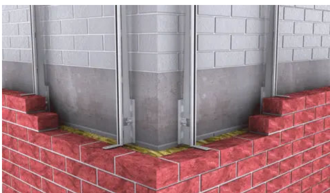
MOSO® Horizontalverbindung HV-A Attikahalteanker
