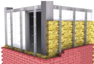
MOSO® Windpostanker HV-WP zum horizontalen Halten der Vorsatzschale
