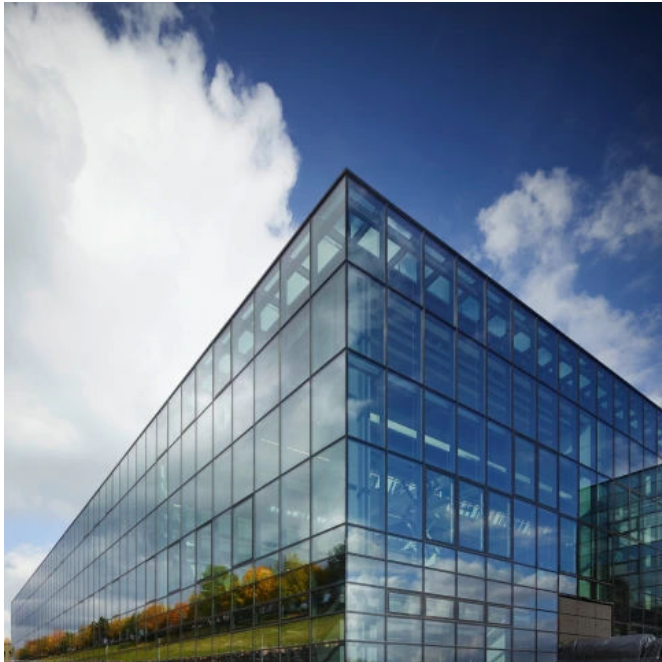
Beheizte Pfosten-Riegel-Fassade aus Stahl und Glas, Glasdach, Lacker Klapp- und Drehfenster bigSwing (© Steffen Schrägle)
