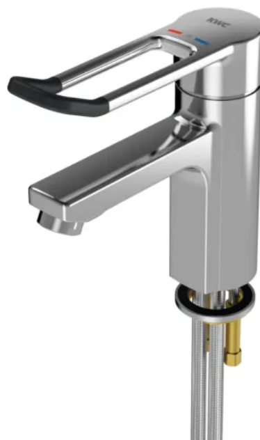
F5L-Therm Thermostat-Einhebel-Standbatterie, barrierefrei. Die Hebelkappe ist ergonomisch gestaltet in Bügelform, im vorderen Bereich mit leichter Wölbung und Basaltgrau beschichtet, nach dem 2-Sinne-Prinzip (taktil und visuell).
