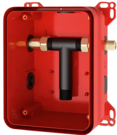
R3 Rohbauset zur Wandeinbaumontage von Fertigbausets DN 15 mit Mischeinrichtung, für Waschanlagen. Zum Anschluss an Warm- und Kaltwasser. Mit Spülstück zum Spülen und Dichtheitsprüfung.
