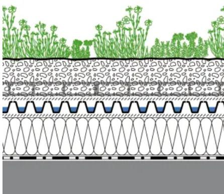
Auf Umkehrdächern dürfen oberhalb der XPS-Wärmedämmplatten keine Schichten aufgebracht werden, die das Ausdiffundieren von Feuchtigkeit verhindern. Deshalb ist die Speicherschutzmatte durch ein diffusionsoffene Trenn- und Gleitvlies TGV 21 zu ersetzen und Wurzelschutzfolien sind – falls notwendig – direkt auf der Abdichtung, also unter den Wärmedämmplatten zu verlegen. Die fehlende Wasserspeicherung der Speicherschutzmatte wird durch eine höhere Substratschicht kompensiert
