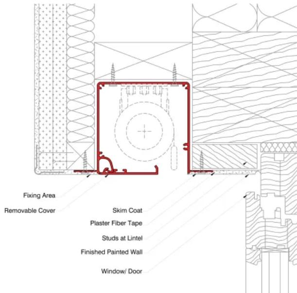
Egal, ob abgedeckt oder komplett verschlossen – mit den patentierten Revisionsklappen können die Einbaukassetten je nach Wunsch angepasst werden. Blindspace® Kassetten garantieren eine einfache und effektive Wartung durch die unkomplizierte Handhabung der Abdeckprofile. Dabei ermöglichen die aus stranggepresstem Aluminium passgenau zugeschnittenen Profile einen montagefreundlichen Einbau.
