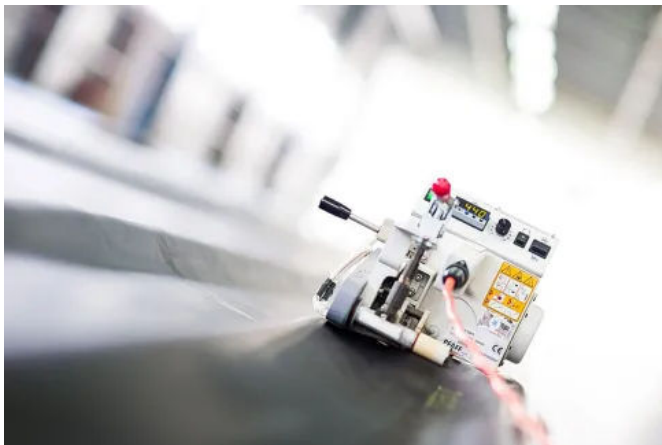
Die NovoProof EPDM Abdichtungen werden objektbezogen aus Endlosbahnen zugeschnitten.
