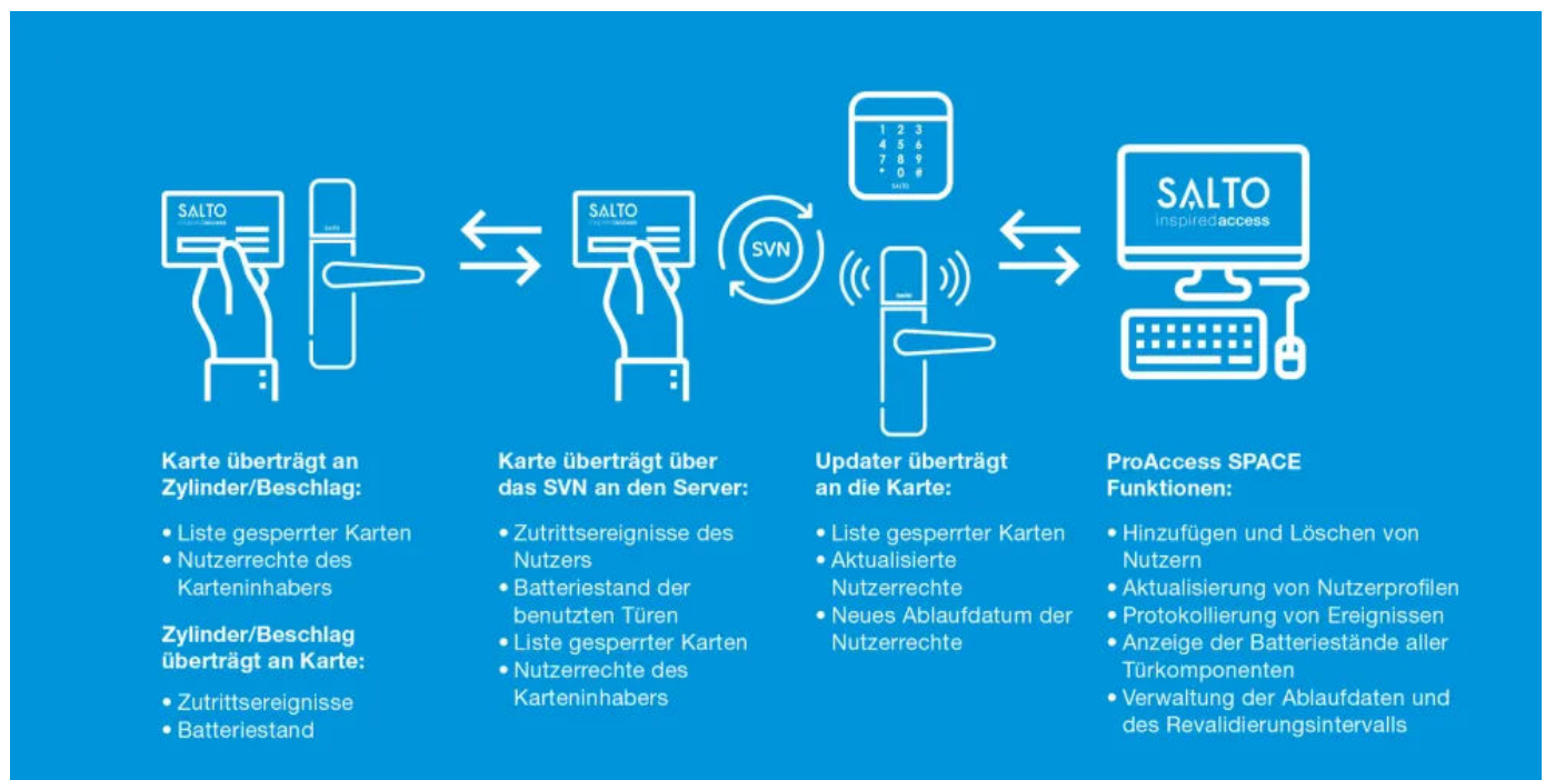
Funktionsweise des Salto Virtual Network (SVN)
