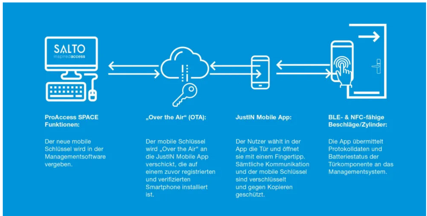
Funktionsweise der Smartphone-basierten Zutrittslösung JustIN Mobile
