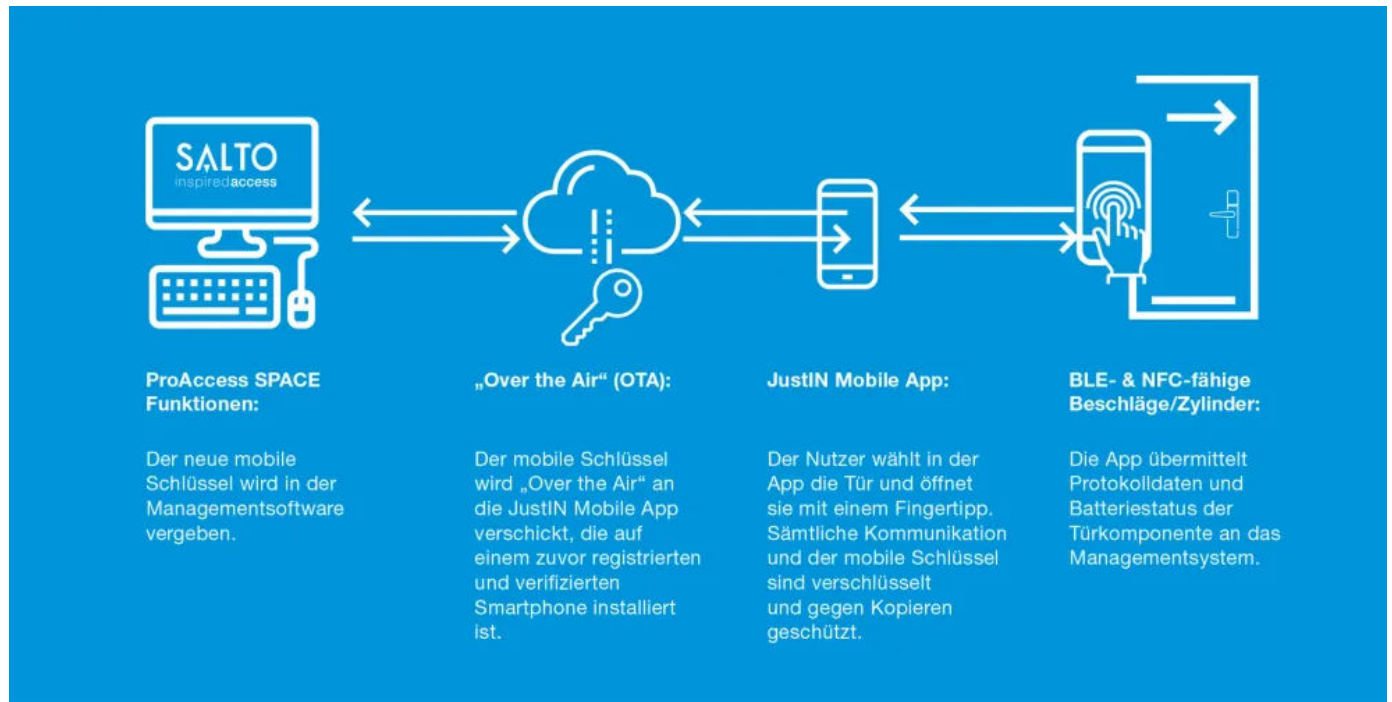
Funktionsweise der Smartphone-basierten Zutrittslösung JustIN Mobile
