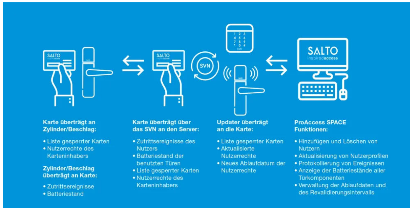
Funktionsweise des Salto Virtual Network (SVN)
