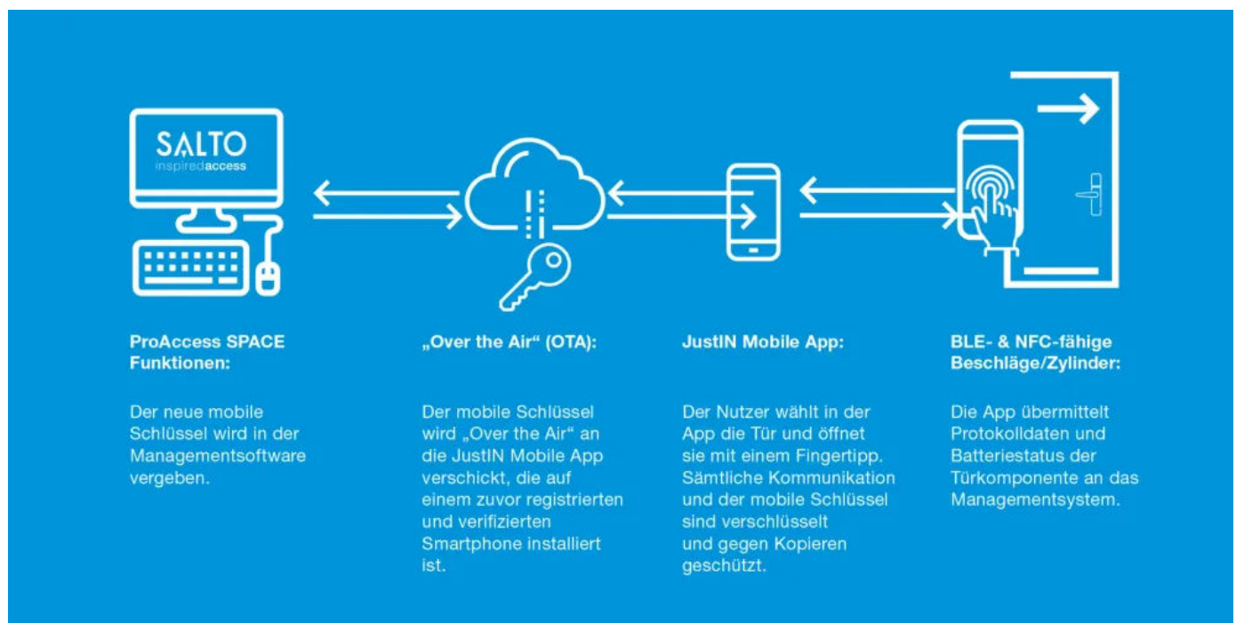
Funktionsweise der Smartphone-basierten Zutrittslösung JustIN Mobile
