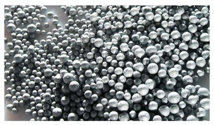
HIRSCH PoroBead 033 Dämmstoff-Granulat aus expandiertem Polystyrol (EPS) ist besonders geeignet für die nachträgliche Hohlraumdämmung von zweischaligem Mauerwerk. Das diffusionsoffene Granulat ist formstabil, feuchtigkeitsunempfindlich und macht die Kerndämmung damit alterungs- und verrottungsbeständig.
