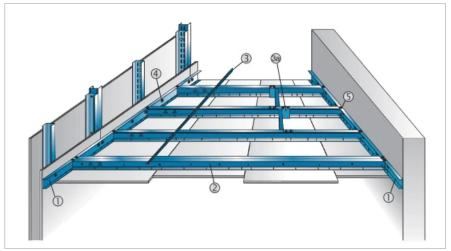
Konstruktionsbeispiel System MINI Wand-zu-Wand-Konstruktion
