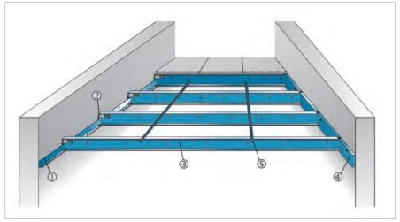
Konstruktionsbeispiel System MAXI Wand-zu-Wand-Konstruktion
