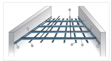
Konstruktionsbeispiel System MIDI Wand-zu-Wand-Konstruktion
