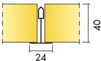
Das System zeichnet sich durch sichtbare Profile und großformatige Paneele aus.
