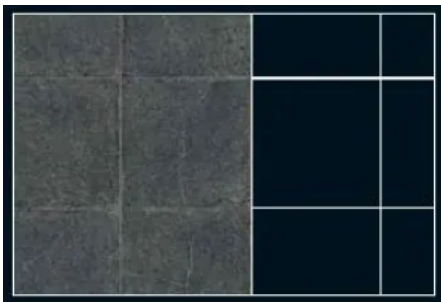
Gerade Verlegung Fliesen
