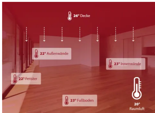
DX-THERM - Deckenheizung im Winter
