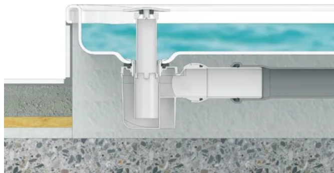
Durch das Herausziehen des Standrohres kann beim TELOS das Wasser angestaut werden. Der integrierte Standrohrüberlauf verhindert Überflutungen.
