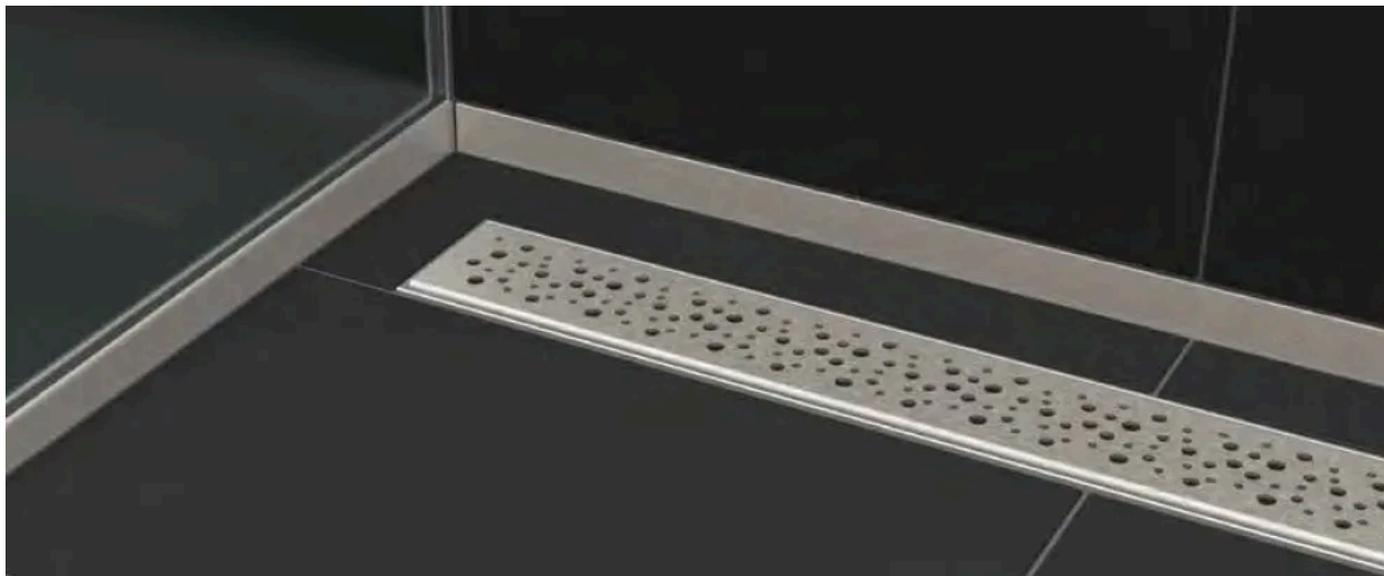
alferline Slim Plus ist ein Duschrinnensystem für besonders niedrige Einbauhöhen. Mit nur 60 mm Gesamtaufbauhöhe eignet es sich gut für Neubauten und auch für Sanierungen. Durch den EPS-Hartschaumblock ist die Positionierung auf dem Estrich einfach und eine zusätzliche Unterfütterung überflüssig. Mit dem zweiteiligen Unterbau kann die Aufbauhöhe von 60 mm bis 80 mm frei variiert werden. Ein Abfluss mit Geruchsverschluss ist bereits integriert.
